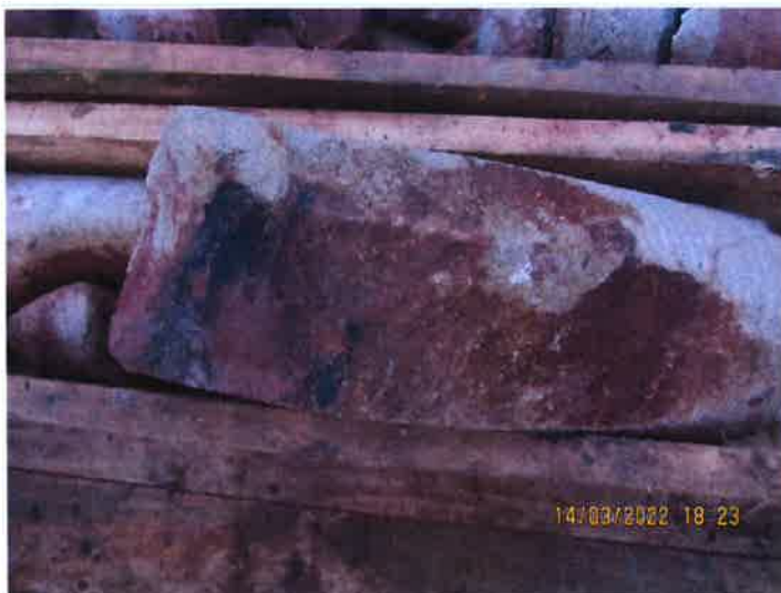
Abb. 5: Steil stehende Kluft im Sandstein mit eisenhaltigem Kluftbelag
